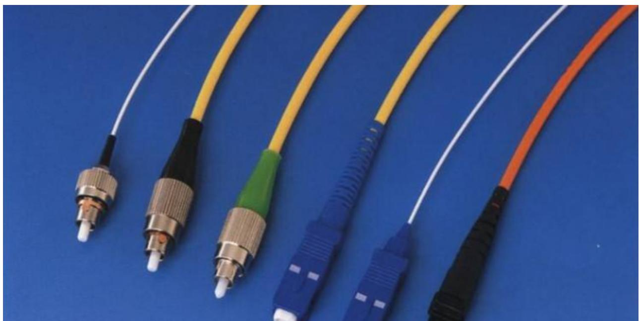
光纤跳线按端接类型分主要有以下三种类型：ST-ST、SC-SC、ST-SC。按光纤种类分主要有单模光纤和多模光纤两类。跳线长度的规格有0.5m、1m、2m、3m、5m、10m等。按线缆外护层材料可分为普通型、普通阻燃型、低烟无卤型（LZSH）和低烟无卤阻燃型等。根据建筑物防火等级和对材料的耐火要求，综合布线系统应采取相应的措施。在易燃的区域和大楼竖井内布放电缆或光缆，应采用阻燃的电缆和光缆；在大型公共场所宜采用阻燃、低烟、低毒的电缆或光缆；相邻的设备间或交接间应采用阻燃型配线设备。新洲区单芯光纤跳线有较厚的保护层，一般用在光端机和终端盒之间的连接。
